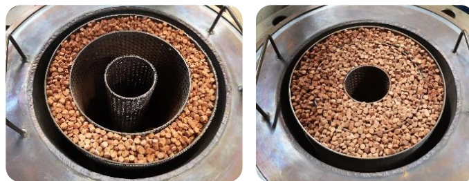
Rys. 1. Widok na pilotowy reaktor SCR-NH 3 z zainstalowanym złożem katalitycznym.
